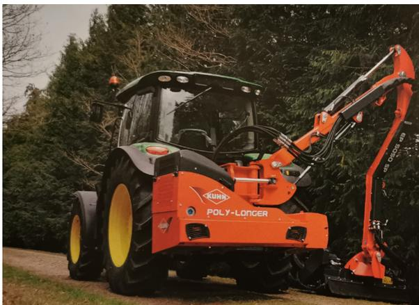
Modèle de la nouvelle épareuse - Photo Kuhn
